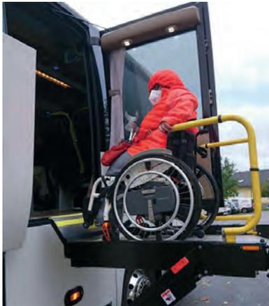
*Rolli-Fahrer werden über den Buslift in den Bus gehoben*
