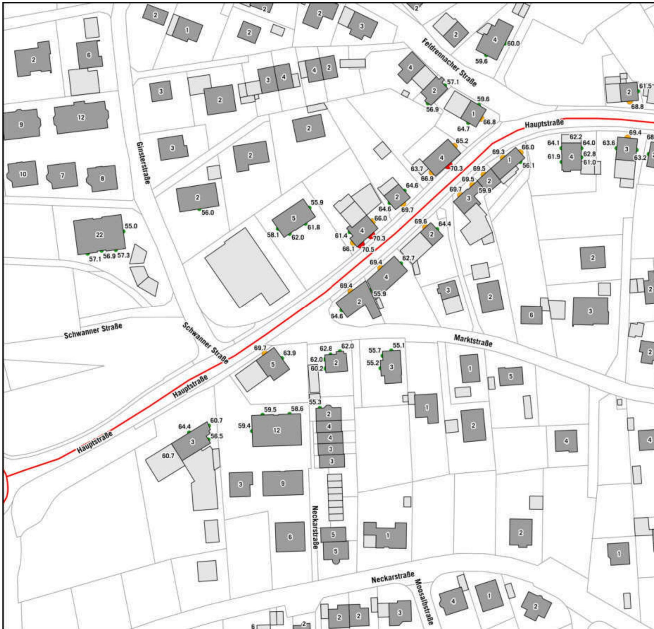
**Fassadenpegel LrT Detail**
